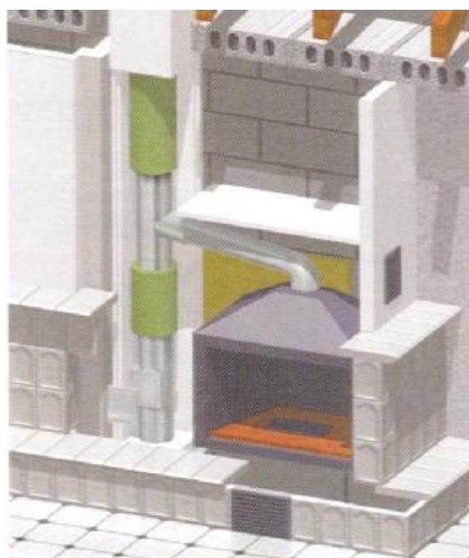
Slika 11: Novo kurišče si lahko postavimo precej svobodno in neodvisno od obstoječega sistema dimnika, saj lahko nov dimnik postavimo skoraj brez omejitev.
