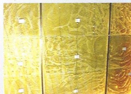
...ob povišani temperaturi se aktivira poseben požarni gel, steklo se spremeni v negorljivo izolativno pregrado.
