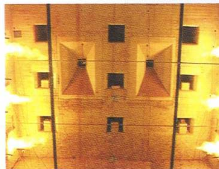
Požarni preskus - stekla so nameščena, temperatura začne naraščati
